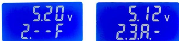
长按TRG按键，自动检测充电器支持哪种快充协议，检测完成后液晶会显示“2.3.A.F”分别对应“QC2.0/QC3.0/AFC/FCP”。不支持时显示“-”
