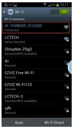
(3) 打开"EasyTCP\_20"APP, 点击"CONNECT", 输入 IP 地址: 192.168.4.1 和端口号 8080, 然后点"Connect",连接成功后,绿灯由 2 秒慢闪变为常亮,点击灰色方块就可以发送指令来控制继电器的开关。
