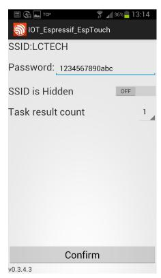
(3)等待配置成功,当 APP 界面出现 ESP8266 的 IP (如 192.168.0.174)地址后说明 ESP8266 模组成功连上了路由器,并自动记忆该账号和密码,下次进入模式 2 会自动连接(约 20-60S 即可连上)
