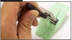
把机身翻转到另一面,用G 1x3螺丝固定升降舵与舵机摇臂(此处升降舵粘贴的加强片在背面),请勿过度拧入螺丝,导致板材变形。
