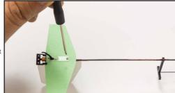
然后用G 1X3螺丝锁定尾翼,螺丝拧入时锁定即可,请勿过度拧入挤压,导致板材变形。
