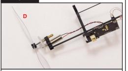
在机身头部插入桨叶。 Install the propeller at the head of the fuselage.
