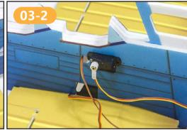
如左图,在机身中部安装舵机,上下 交错安装。舵机线从预留孔整理到同 一侧。
