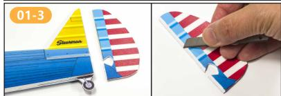
把转向舵从机身切下,用模型刀切割转向舵与机身连接处,切出45度斜面。
