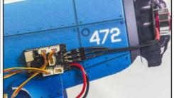
如上图示范微型接收机放置及接线,此处推荐 AEO RX15x-E系列多合一接收机。 需按图焊接插头,或按下面链接参考设置说明书。
