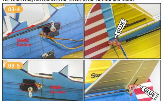
把制作好的一端Z型头穿入舵机的舵臂,然后参考尾翼上舵角的位置,确定连杆合适的长度,并切除多余的碳杆。
