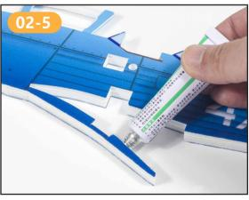
如图所示, 在机身预留的机翼插槽内涂抹泡沫胶, 两面
