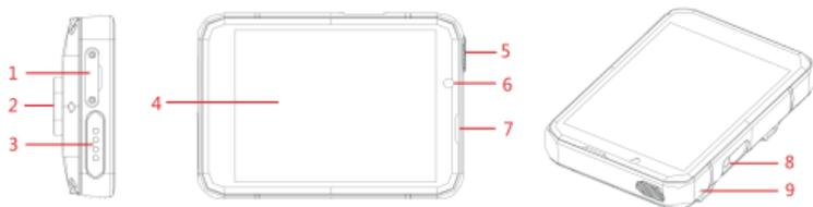
1. Nano SIM 卡槽; 2.心率; 3.磁吸充电; 4.显示屏; 5.开机键; 6.前摄像头; 7. 扬声器; 8.侧摄像头; 9.麦克风
