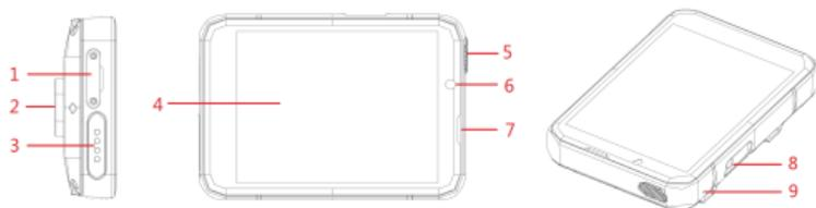
1.NanoSIM カードスロット;2.心拍数センサー;3.磁気充電;4.表示;5.電源キー;6.フロントカメラ;7.スピーカー;8.サイドカメラ;9.マイク
