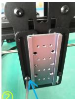
②. Ziehen Sie die Verriegelungsschrauben der Gleitschiene fest
