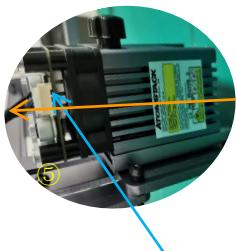
⑤.Connectez le signal 3 broches de la carte de commutation et insérez le port 4 broches du laser
