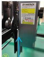
③. Setzen Sie den Laser in den Schieber ein
