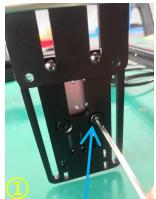
①. Installieren Sie die Gleitschraube und ziehen Sie sie fest
