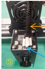
⑤. Schließen Sie das 3-Pin - Signal von der Schalttafel an und stecken Sie den 4-Pin-Anschluss des Lasers ein
