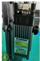
④.Serrez l'écrou de blocage du laser
