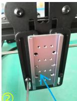
②.Serrez les vis de verrouillage de la glissière
