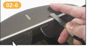
用模型刀切割舵面与尾翼连接处,切出45度斜面。使舵面可以自由摆动。
