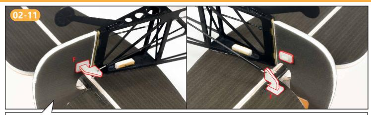
然后对照连杆制作步骤安装另一端的Z型头。
