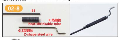
如左图,截取合适长度的热缩管,把Z型钢丝和碳杆套再一起,加热热缩管缩紧,然后点入少量CA胶加固。
