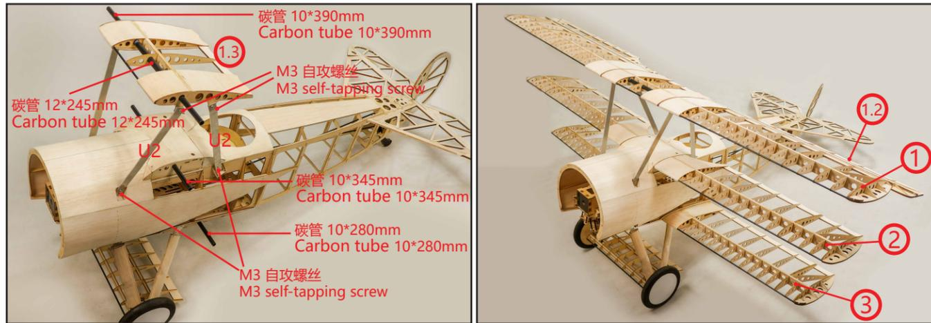
上机翼锁定位置 Upper wing locked position 中机翼锁定位置 Middle wing locked position 下机翼锁定位置 Lower wing locked position
