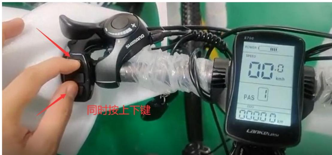
3、按 M 键调至 PO8（Press the M key to switch to PO8）
