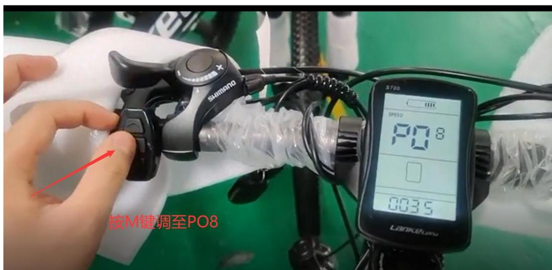
4、按上下键调设置速度（Press the up and down key to set the speed）
