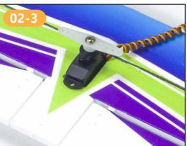
把02-1步骤粘好的机 翼翻转,装入舵机并把 舵机线放置到正面。 如左图安装)此处舵机 不要粘。
