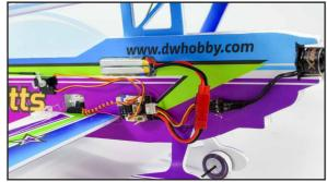
上图示范电池放置位置,用刀延虚线切开槽位放置电池,如自备电池不适合孔位可不切开。
