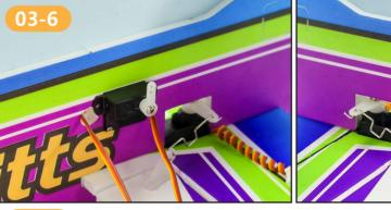
如左图,在机身中部安装舵机,上下交错安装。舵机线从预留孔整理到同一侧。
