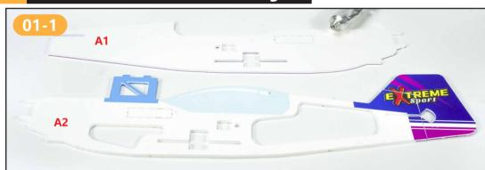
在两片A1的反面均匀涂抹泡沫胶。 在A2的两侧均匀涂抹泡沫胶。 Spread foam glue evenly on the reverse sides of the two pieces of
