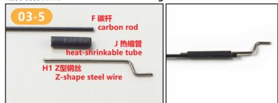
如左图,截取合适长度的热缩管,把Z型钢丝和碳杆套再一起,加热热缩管缩紧,然后点入少量CA胶加固。
