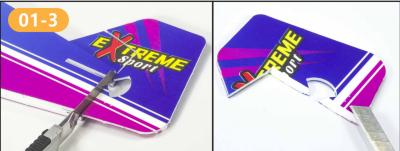
把转向舵从机身切下,用模型刀切割转向舵与机身连接处,切出45度斜面。
