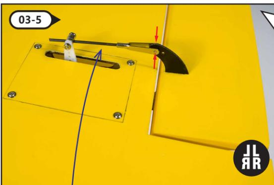
在副翼预留槽内安装舵角，在舵机臂上安装快装接头。把连杆夹头一端夹住舵角，另一端穿入快装接头并锁定。
