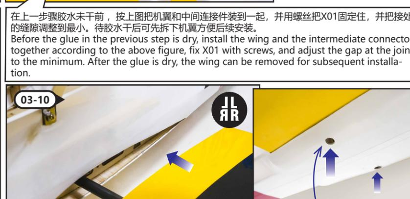
在上一步骤胶水未干前，按上图把机翼和中间连接件装到一起，并用螺丝把X01固定住，并把接处的缝隙调整到最小。待胶水干后可先拆下机翼方便后续安装。
