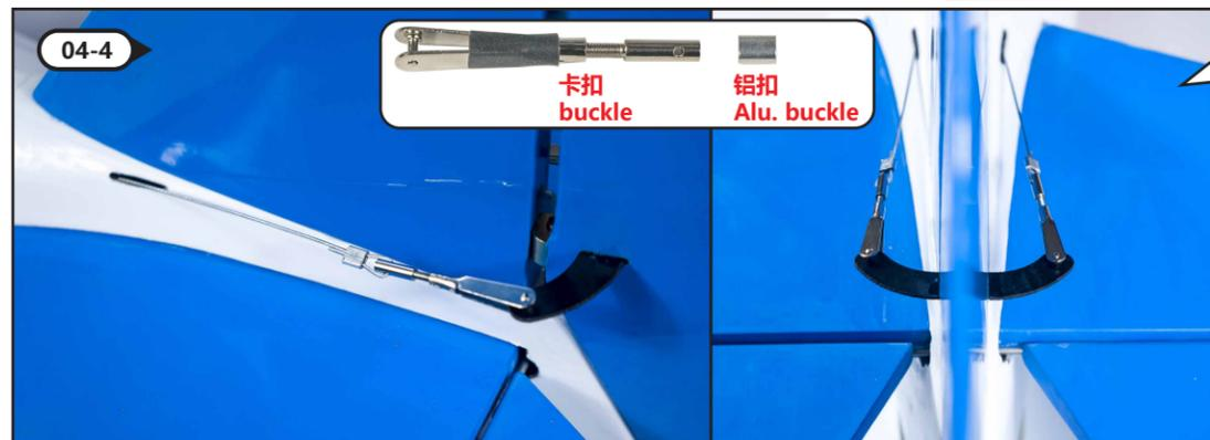
方向舵通过两根钢丝绳拉线与舵机相连，安装方式见04-4,04-5,04-6图示。
