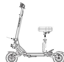
3.Obróć pokrętło i zablokuj zatrzask składania.
