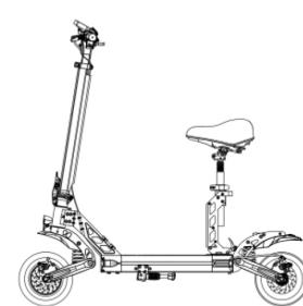
3. Agite el soporte del asiento para confirmar que el eje del asiento está atascado en la ranura para tarjetas.
