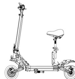
2.Quando la staffa del sedile ècompletamente eretta, rilasciarel'albero del sedile in modo che l'albero del sedile sia bloccatonella fessura.
