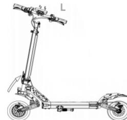
3. Drehen Sie das Gerät nach vorne, um die Schraubenlöcher freizulegen, setzen Sie die Schrauben ein und ziehen Sie sie mit einem Schraubenschlüssel fest. Drehen Sie dann das Gerät zurück und ziehen Sie die Schrauben auf beiden Seiten des Geräts mit einem Schraubenschlüssel fest
