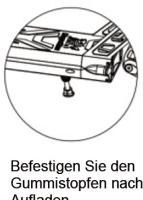
1. Öffnen Sie den wasserdichten Stecker des Ladeanschlusses und stecken Sie den Ladestecker in die Ladeöffnung am Körper.
