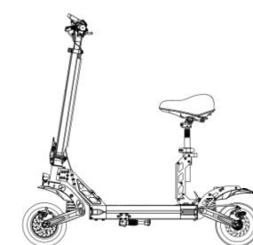
4.Wenn bestätigt wird, dass die Sitzwelle im Schlitz verriegelt ist,heben Sie den Schnellspanner des Sitzes an und verriegeln Sie ihn.
