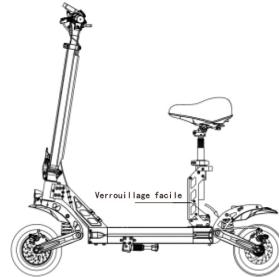
2. Pressez l'axe du siège à côté.
