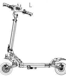
2. Po postawieniu sztycy do przodu, pociągnij do góry klamrę składanego, potem zablokować blokady składanej.
