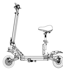
4. Cuando se confirme que el eje del asiento está atascado en la ranura para tarjetas, levante la liberación rápida y ciérrela con fuerza.
