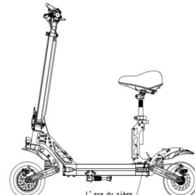
3. Lorsque l'axe est pressé au bout, couchez lentement le siège en tenant le support avec la main.
