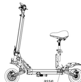
3.Dopo aver abbassato completamente l'asta del sedile, tenere la staffadel sedile con una mano e abbassare lentamente il sedile.
