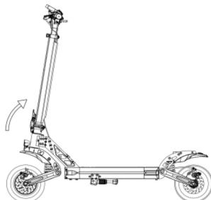
4.Después de bloquear la carpeta, verifique si el cuerpo tiene tornillos que se caen y se aflojan antes de montar.
