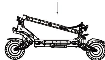
2. mit einer Hand den Hebel halten und mit der anderen Hand den Federstift nach außen ziehen
