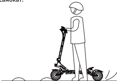
11. Не позволяйте изделию впитываться в воду более чем на 1 см, чтобы избежать повреждения электрических частей самоката из-за попадания воды.
