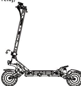
3. Baje la palanca de carrocería
