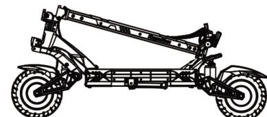
4. Отрегулируйте рычаг тела самоката, чтобы убедиться, что крючок помещен в прорезь и закреплен на месте
