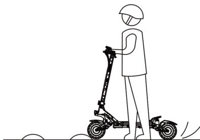
11. Non immergere il prodotto in acqua con una profondità superiore a 1 cm per evitare di danneggiare le parti elettriche del veicolo a causa dell'ingresso di acqua
