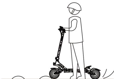
11.Nie należy zanurzać skuteru w wodzie na głębokość większą niż 1 cm, aby uniknąć uszkodzenia części elektrycznych skutera na skutek przedostania się wody.
