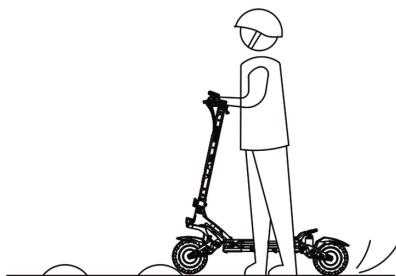
11.Ne conduisez pas dans l'eau à plus de 1 cm de profondeur. Évitez d'endommager les pièces électriques de la trottinette en raison de l'infiltration d'eau
