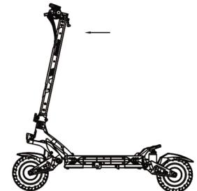
4. Используйте инструменты, входящие в комплект поставки, чтобы затянуть винты, и проверьте, правильно ли работает выключатель питания после завершения сборки.
