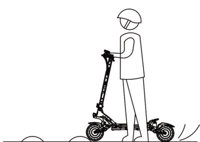
11. No sumerja el producto en agua a más de 1 cm de profundidad para evitar daños en las partes eléctricas del scooter debido a la entrada de agua
