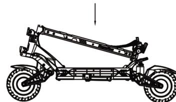
4.Ajustez la tige pour assurer que le crochet s'insère dans la fente et se met en place.
