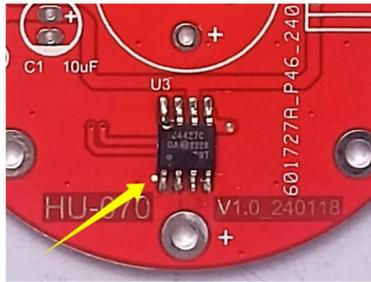
1、焊接 TC4427 芯片，注意芯片丝印与电路板丝印对齐（芯片丝印上的白点对应电路板丝印的白点）。
