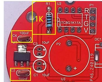
3、焊接 1K 电阻和 100nF 电容，电阻和电容不分正负极。
