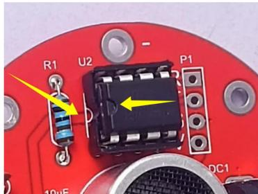
9、把芯片插入 IC 插座里面，注意芯片缺口方向与电路板丝印对应。
