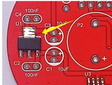
2、焊接 AMS-1117，与电路板丝印对齐，注意焊接时，引脚不要虚焊。
