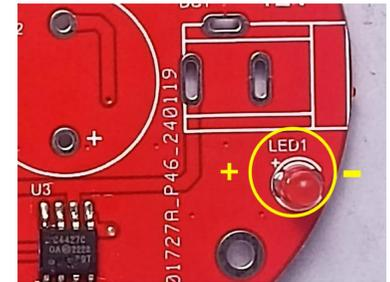
4. 焊接红色 LED 灯，注意灯的引脚，长正短负，与电路板丝印对齐后进行焊接。
