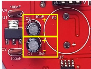
6、分别焊接电容容值为 10uF 的 C1、C3 电解电容，注意电解电容正负极。
