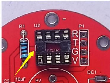
5、焊接 8 脚 IC 插座，注意缺口方向与电路板丝印对齐。
