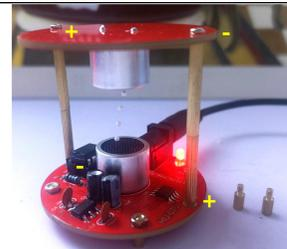
11、方案一：用 M2X23，M2X20+4 和 M2X4 螺丝进行固定两个电路板，电路板的正极对应负极，负极对应正极。（悬浮效果强，实用性更高）
