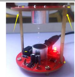
12、方案二：在方案一的基础上增加两个 M2X5+3 的铜柱。（更加美观，但是悬浮效果较差，建议使用方案一）
