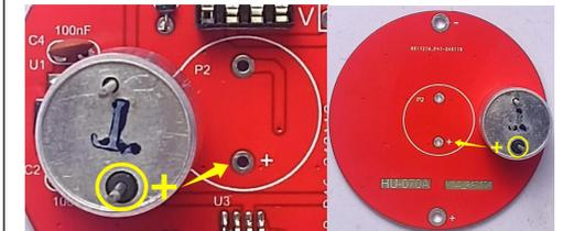
8、焊接两个超声波传感器，注意正负极（超声波传感器上有黑色圆圈的为正极）。
