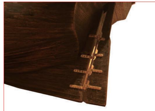
尾舵铰链制作应保持水平，使用铁钉和胶水固定牢固，然后使用铁钉将船身和尾舵串起来。
