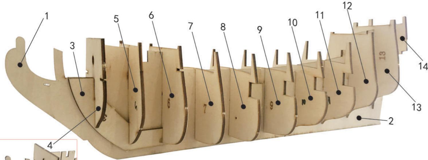
安装助骨时如果感觉过紧，不要强行插入龙骨。打磨卡槽内侧，拓宽卡槽后再安装。
