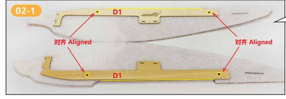
在机身侧板上粘贴木件D1,粘 贴时,木件的圆孔对准机身侧板
