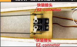
在机身中部安舵机,舵臂上安 3 装快装接头,钢丝连杆穿入快 装接头并锁定。
