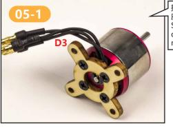
把马达固定到马达 座D3上。 Secure the motor onto the motor mount D3.
